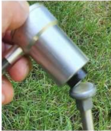
Figura 2: piezosensore del terreno, porre particolare attenzione nel connettere il piezosensore ai puntali tramite magnete
