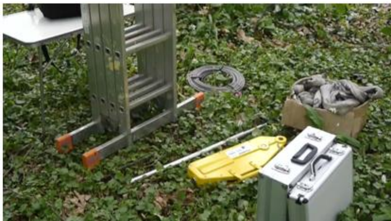
Figura 3: attrezzature necessarie ad effettuare Pulling Test. Attenzione che il tirfor qui fotografato non è compreso nella fornitura e può essere sostituito da altri apparati.
