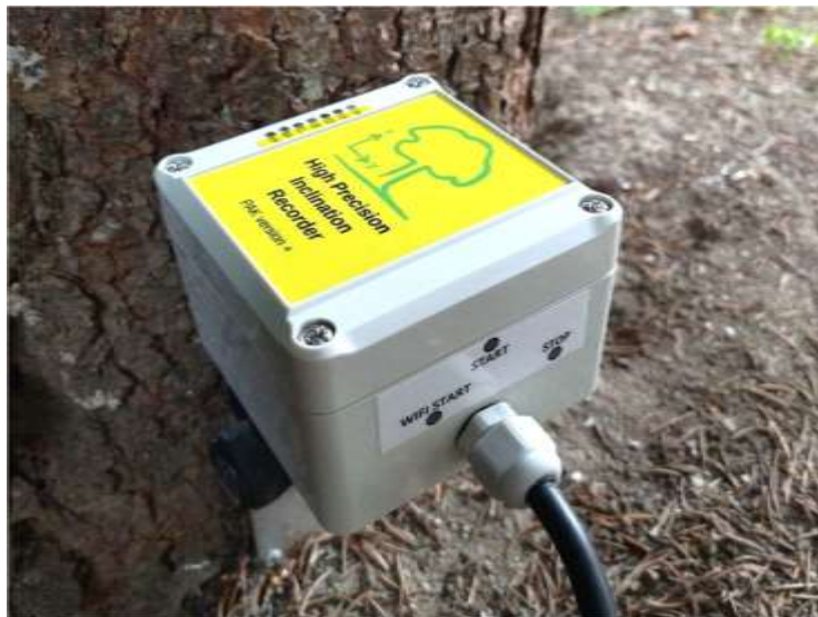
Figura 10: Unità inclinometro "High Precision Inclination Recorder" con LED di verifica del funzionamento
