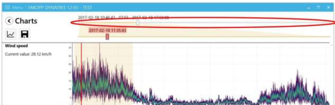
Figura 20: il cursore superiore è dotato di due tasti bianchi con i quali è possibile selezionare un periodo dell'intera prova da sottoporre all'analisi del software
