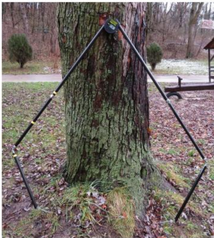
Calibro Bluetooth FaKopp con assetto per misure fino a 1999 mm
