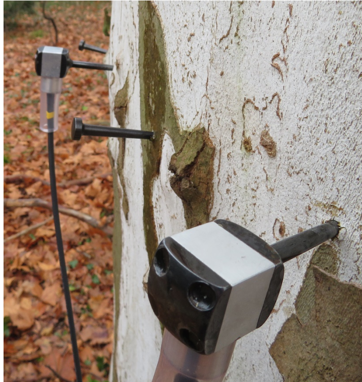
I sensori Ludwig s'infiggono nel legno alla stessa profondità di quelli normali.
