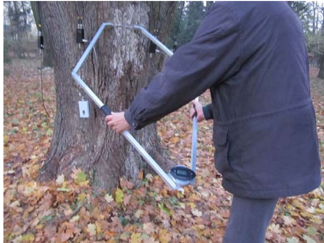
Taratura del punto '0000' premendo il pulsante
